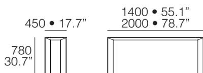
O diferencial da coleção Compasso está no design, com angulações convergentes (chanfros) dos tampos e pés. Os tampos são construídos em painel leve de 55mm de espessura e as bordas com 10mm. Pés em MDF, são fixados ao tampo através de chapa metálica.
